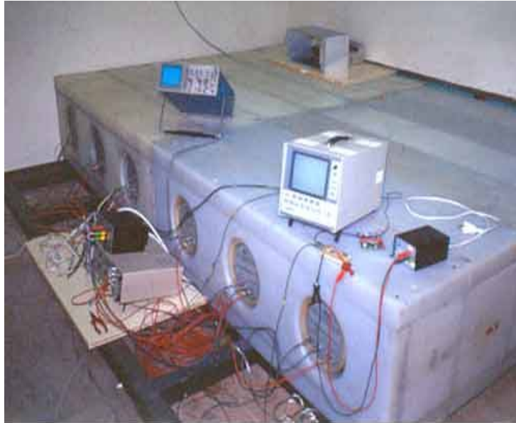
Σχ.3.- Η ανιχνευτική διάταξη του σταθμού της Αθήνας
